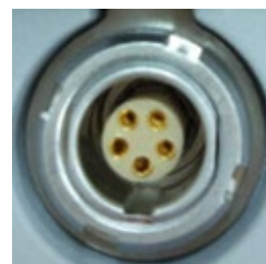
図 4.1 TNC コネクタ 図 4.2 7ピン LEMO コネクタ 図 4.3 5ピン LEMO コネクタ
