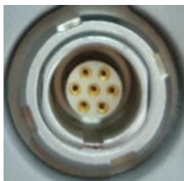
図 4.1 TNC コネクタ 図 4.2 7ピン LEMO コネクタ 図 4.3 5ピン LEMO コネクタ
